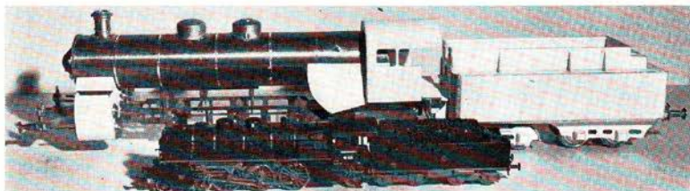
Die wichtigsten Einzel-Bauteile der S 3/6: Kessel, Führerhaus, Zylinderblock, Rahmen und Quertraversen (die Messing-Distanzstücke werden bei der Endmontage noch entfernt) und die Pufferbohle.
